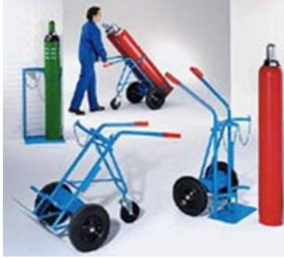
Şekil 5. Tüplerin Güvenli Taşınmasında Kullanılacak Ekipman Örnekleri (AIGA)
