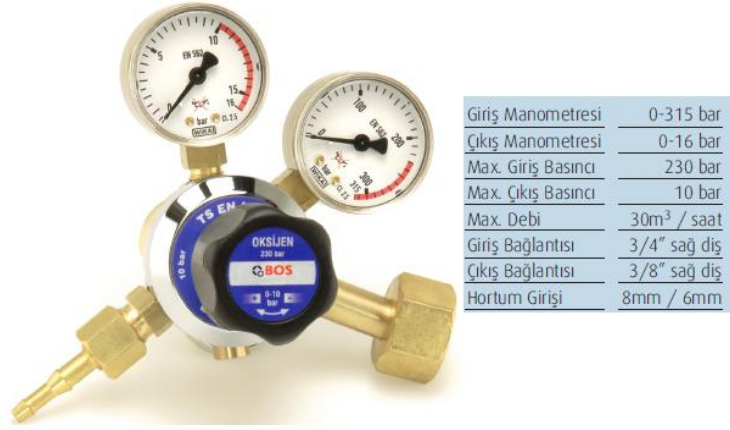
Şekil 1. Tek Kademeli Oksijen Regülatörü ve Özellikleri
